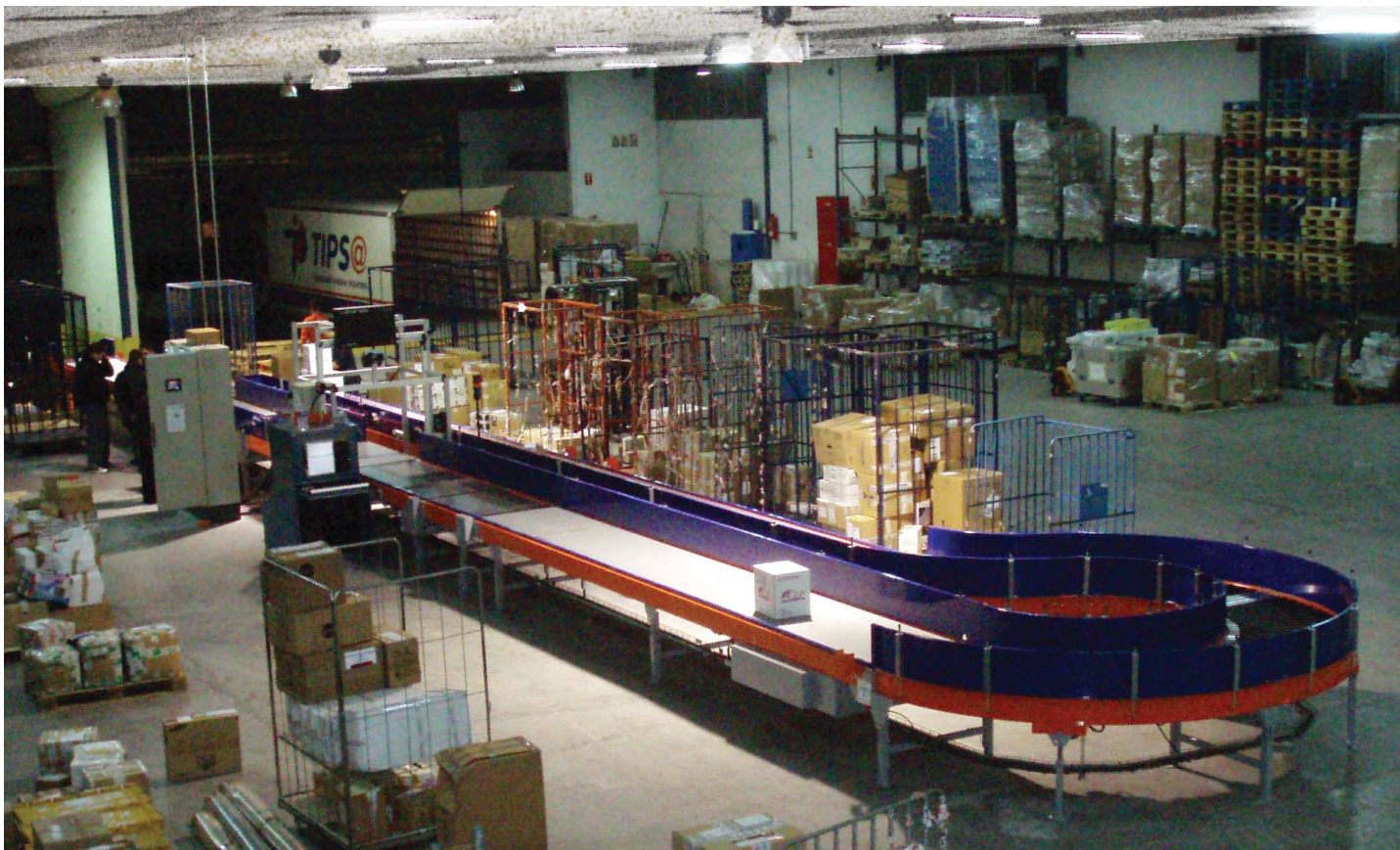
Cintas Automáticas de paquetería que incorpora slot extensible para facilitar la descarga
