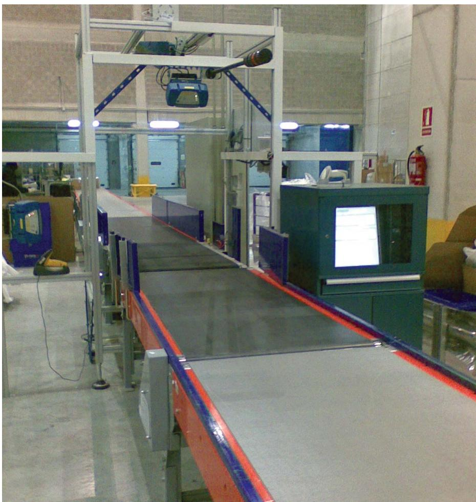
Cinta dotada de escáner, arco volumétrico láser y báscula
