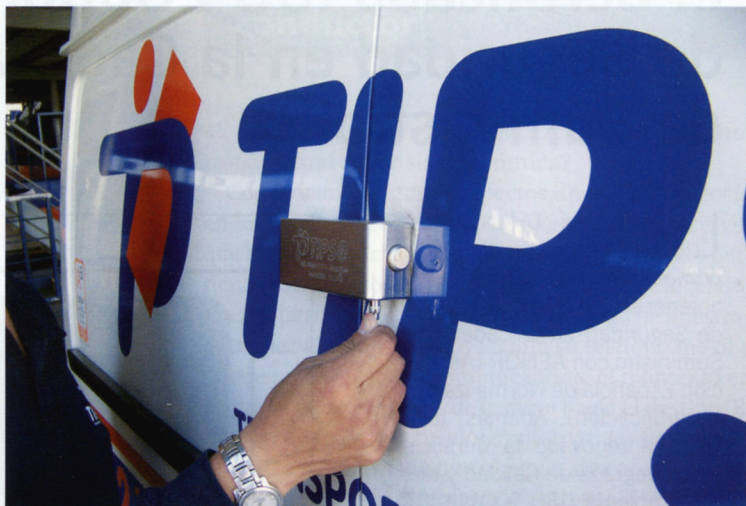
El nuevo modelo de cierre pretende ser un elemento de resistencia ante los métodos de corte tradicionales.
